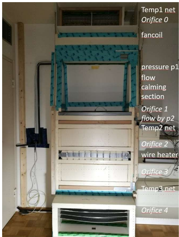
Abbildung 22 Messkanal vor dem Schließen der Frontplatten und Vertikalschnitt (senkrecht zur Ansicht im Foto; rechts)
